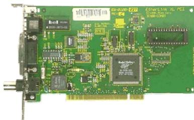
Figura 9 - Scheda di rete dotata di vari tipi di porte
